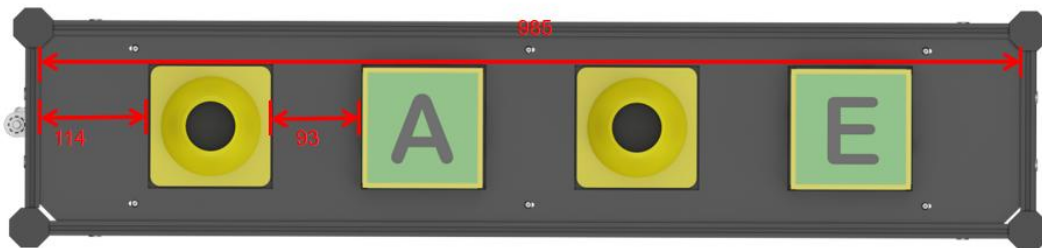
图 4.2-10 可移动资源岛示意图（俯视图）
