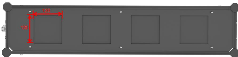
图 4.2-11 凹槽示意图（俯视图）
